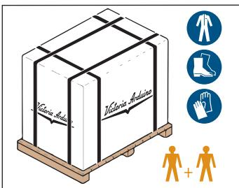
La macchina viene trasportata in pallet con più macchine dentro scatoloni assicurati al pallet con delle centine.
