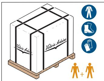
La machine est transportée sur des palettes avec d'autres machines et à l'intérieur de cartons fixés aux palettes au moyen des courroies appropriées.
