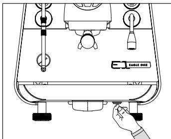
Mettez la machine sous tension en appuyant sur le bouton de commutation situé en bas à droite.
